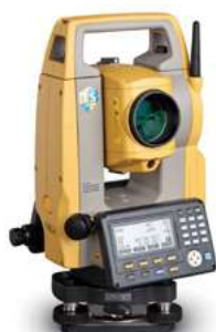
03 Máy toàn đạc
